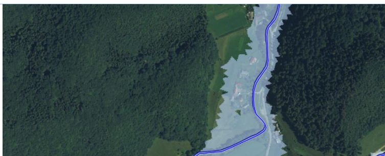
Râul Buzău amonte confluența cu râul Dalghiu – zona inundată Q 10%. Imediat aval de confluența cu râul Dalghiu este inundat DC49A pe cca 590 m, precum și un număr important de case.
