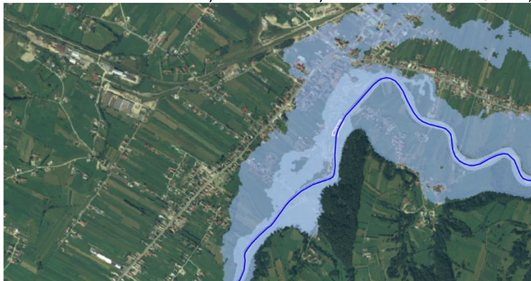
Râul Buzău – Întorsura Buzăului – zona inundată la Q 10% și Q 1%. Localitatea Întorsura Buzăului este inundată semnificativ la Q 1%, un mare număr de case și locuințe fiind afectate. De asemenea este inundat DN 10 pe cca 300 m. În apropierea râului adâncimea apei este cuprinsă între 1-2 m, iar pe porțiuni restrânse chiar între 2-5 m.
