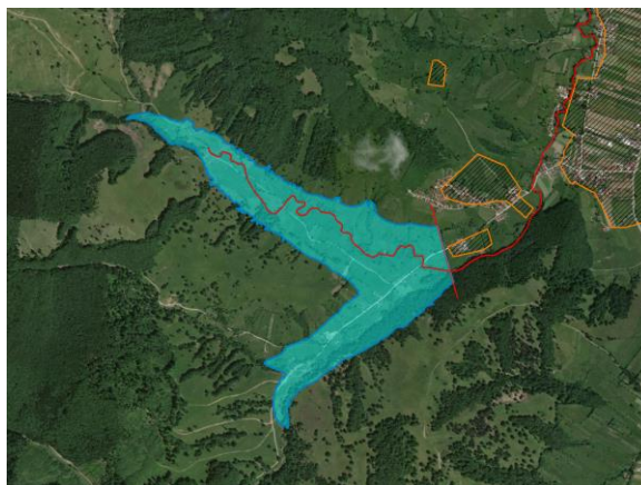
Acumularea nepermanentă Acriș – locația 2 V_{\text{reservoir}} = 9 \text{ mil. m}^3 H_{\text{dam}} = 30 \text{ m} Aproximativ 10 case de relocat
