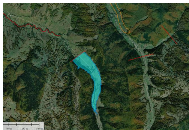
Acumularea nepermanentă Buzău, amonte de confluența cu afluentul Dălghiu V_{\text{reservoir}} = 7 \text{ mil. m}^3 H_{\text{dam}} = 30 \text{ m}
