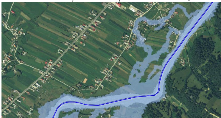
Râul Buzău – aval confluența cu râul Afiș – zona inundată la Q 10% și Q 1%.
