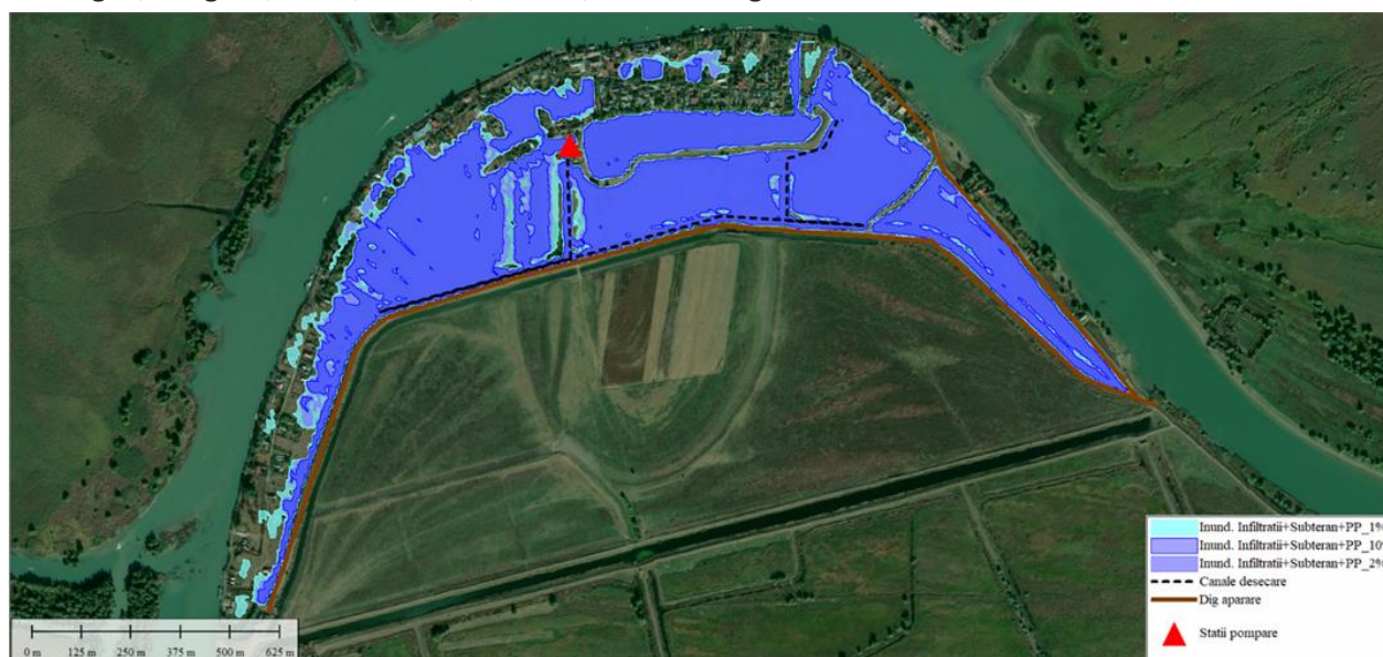
Figura 1: Zona maxim afectată de inundație provenită din sursa pluvială, infiltrații și apă subterană, loc. Mila 23a
