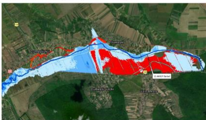
Figura 4-2 – Efectul măsurii din zona localității Dumești (îndepărtare dig mal drept și supraînălțare drum)
