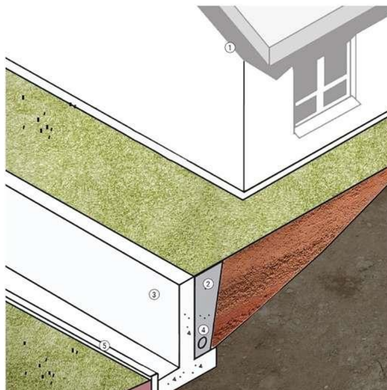
Fig. 34. Exemplificare perete de sprijin în relație cu construcția. 1 - construcție, 2 - umplutură din pietriș grosier sau piatră spartă, 3 - zid de sprijin, dimensionat prin calcul structural, cu barbacane de evacuare a apei infiltrate, amplasate la partea inferioară, 4 - tub perimetral de drenaj cu diametru mai mare de 80 mm prevăzut cu sistem de evacuare a apei către exterior, 5- trotuar de protecție
