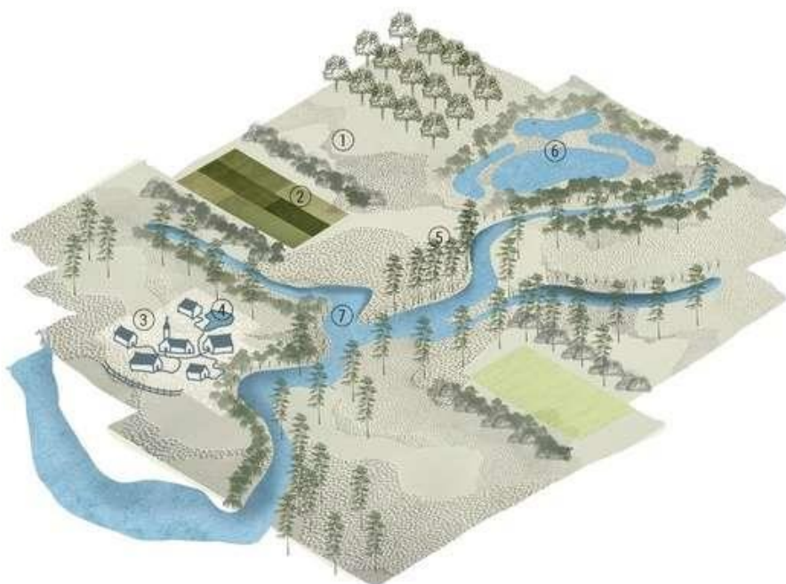
Fig. 3. Schemă de exemplificare a măsurilor naturale de retenție a apei. 1 - fâșii plantate și garduri vii, 2 - rotația culturilor, 3 - Suprafețe permeabile, 4 - iazuri de stocare, 5 - păduri în lunca râului, 6 - zone împădurite, 7 - restaurarea și managementul zonelor umede, 8 - renaturalizarea cursuri de apă
