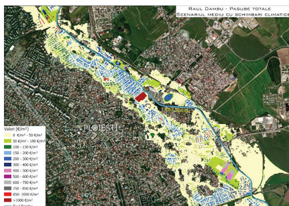
Fig. 6 - Exemplu hartă de risc: modelare ciclul 2 – Râul Dâmbovită – Oraș Ploiești (ABA Buzău-Ialomița) – Scenariul 1% plus schimbări climatice
