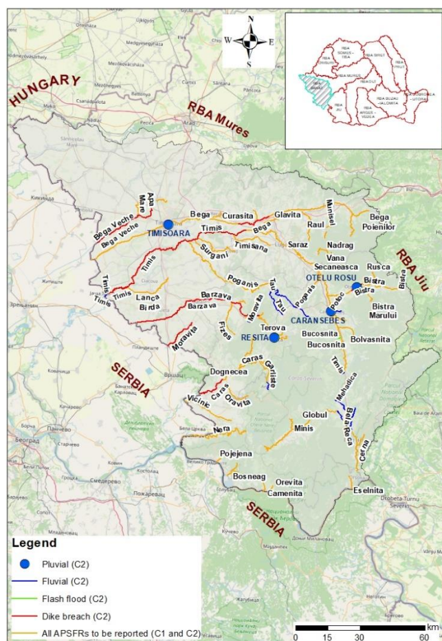
Figura 1 Prezentare generală a APSFR-urilor și tipurile de modelare utilizate pentru ABA Banat
