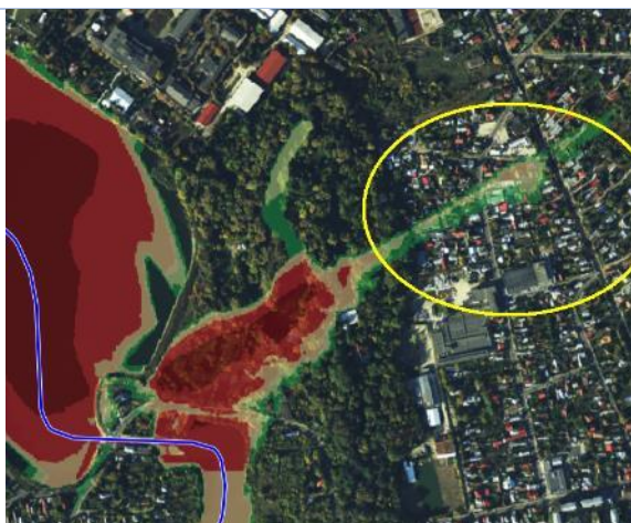
Buciumeni: Două zone inundate pe malul stâng. Cauzată de depresiunea locală și nivelul ridicat al apei din lac. Ar putea fi rezolvată cu reguli de exploatare adecvate.
