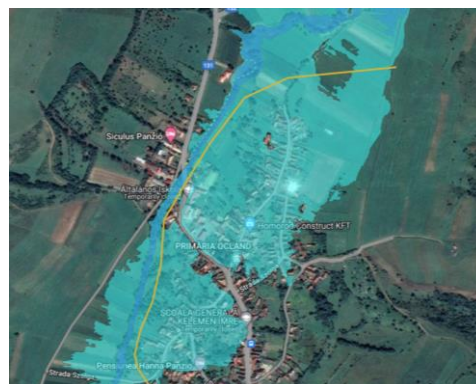
Analiza relocare/demolare diguri existente loc. Ocland
