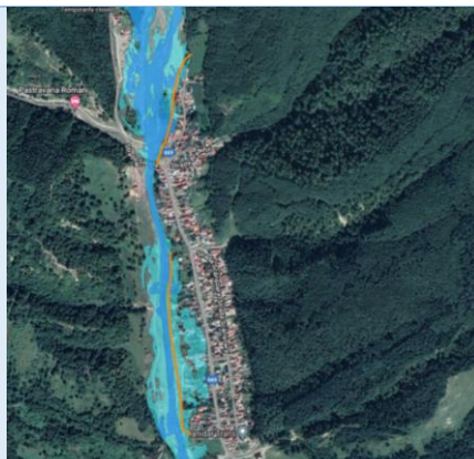
Diguri amonte si aval de pod str. Saliste L = 1,1 \text{ km} , h = 1,5 \text{ m} , loc. Romanii de Sus
