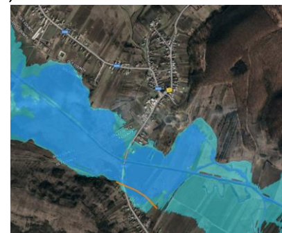
Diguri noi aval loc. Prisaca L = 0,35 km, h = 1,5 m
