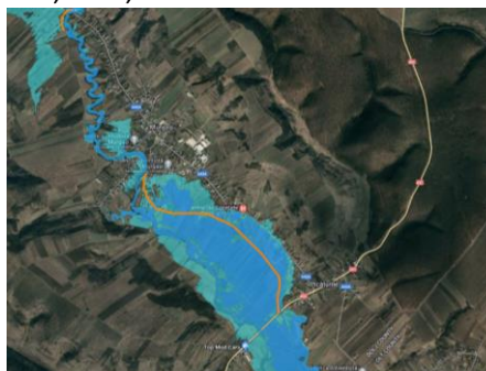
Diguri noi loc. Murgasi L = 1,9 km, h = 1,5 m
