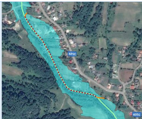
Suprainaltare diguri existente in zona loc. Igoiu (L = 0,6 km)
