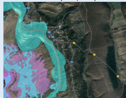
Suprainaltare diguri existente in zona loc Morunglav (L = 2,55 km);
