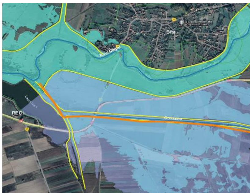
Figure 2 2. Suprapunerea benzilor de inundabilitate 1% ale r. Covasna (mov) și r. Negru (turcoaz) la confluență, sursa Ciclu 1 (pentru r. Covasna) și Ciclu 2 (pentru r. Negru) (dig – linia galbena, lucrari de regularizare – linia portocalie)
