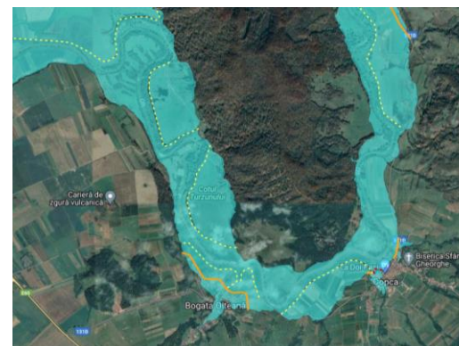
Diguri noi pentru a forma incinte inelare in loc. Bogata Olteană (L=1,2 km, =1,5m),
