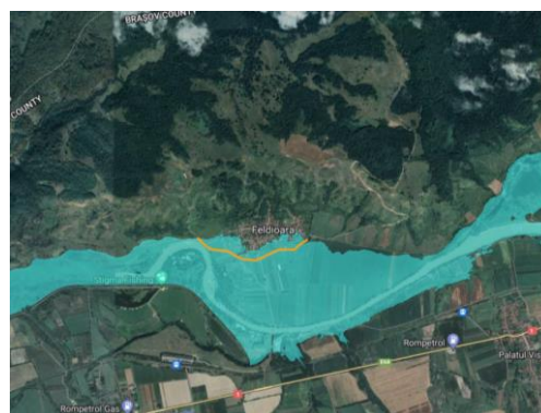
Diguri noi pentru a forma incinte inelare in loc. Feldioara (L=1,2 km, h =1,5m)
