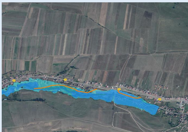
Diguri pe malul drept al r. Belin in zona amonte a loc. Belin si loc. Belin Vale, L = 0,85 \text{ km} , h = 2 \text{ m}
