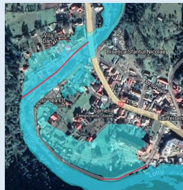
Consolidari de mal cu ziduri de piatra in aval de podul DN 7A loc. Voineasa, L = 300 m
