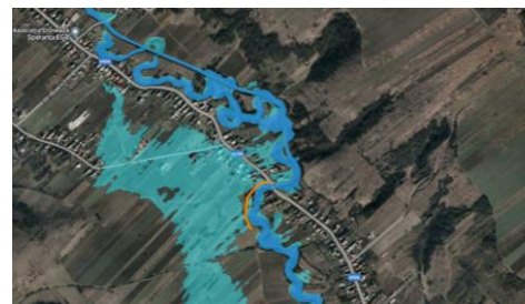
Diguri noi aval loc. Gaia L = 0,2 km, h = 2 m
