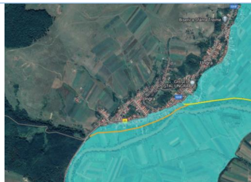
Diguri noi loc. Ungra, L=1,2 km, h=1,5 m
