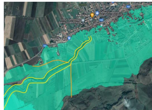
Diguri noi pentru a forma incinte inelare r. Baraolt, loc. Baraolt, L=1,3 km, h = 1,5 m
