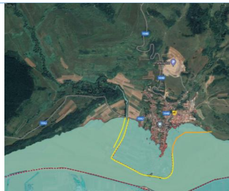
Diguri noi pentru a forma incinte inelare in loc. Făgăraș (L=0,6 km, h =1,5m)
