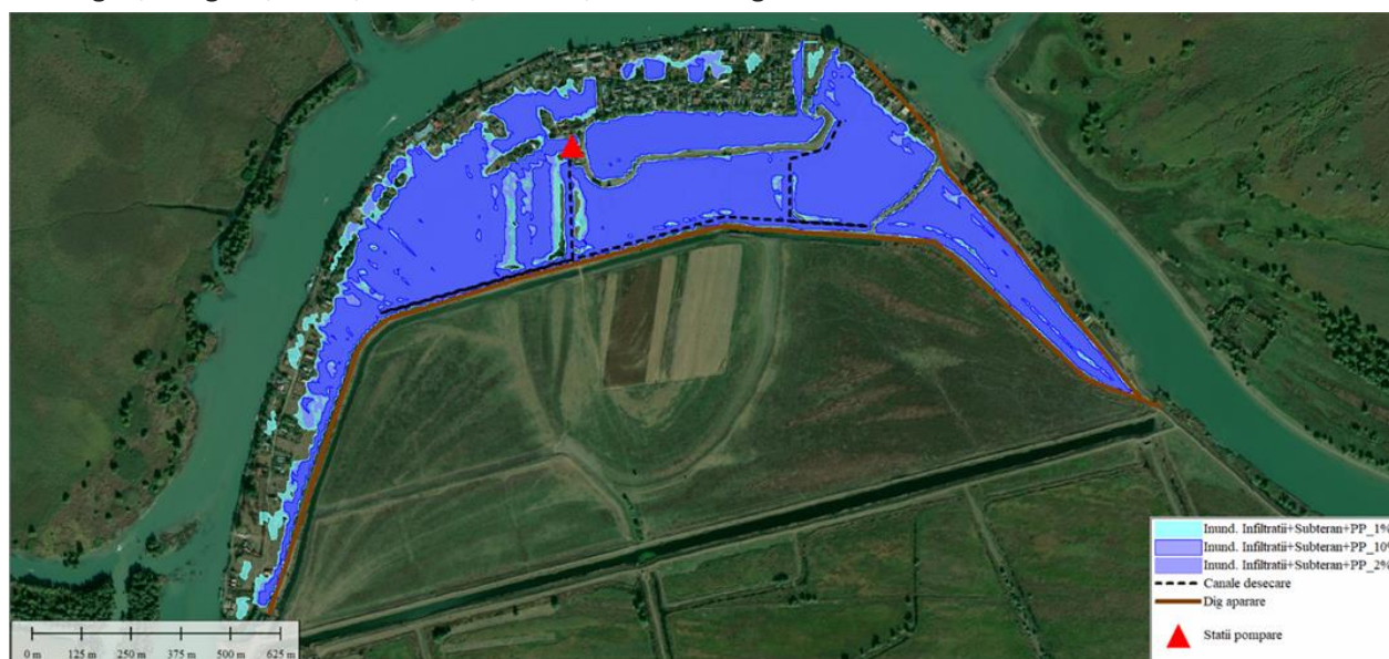
Figura 1: Zona maxim afectată de inundare provenită din sursa pluvială, infiltrații și apa subterană, loc. Mila 23a
